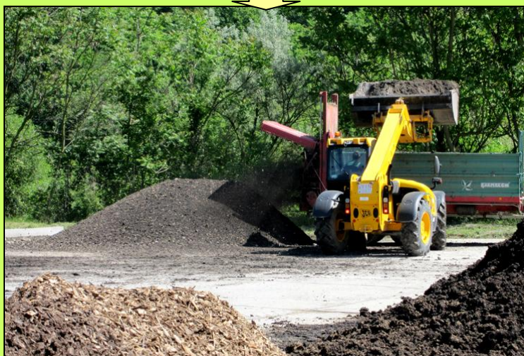
az alapanyagok homogenizálása, keverése prizma építése
